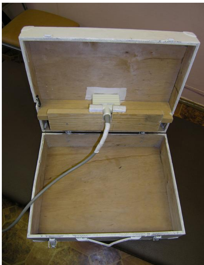
Рис. 1. Способ фиксации линейного датчика ультразвукового аппарата в подставке.
