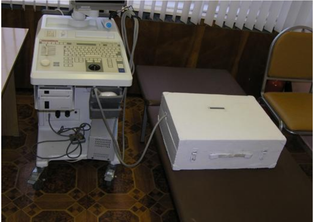
Рис. 2. Подставка для фиксации линейного датчика ультразвукового аппарата (устройство готово к работе)
