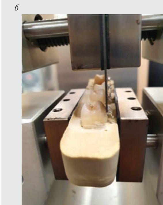
Рисунок 1 — Эксперимент определения силы сдвига брекета относительно вестибулярной поверхности зуба: а — универсальная испытательная машина Criterion 43; б — процесс перемещения пуансона к брекету
