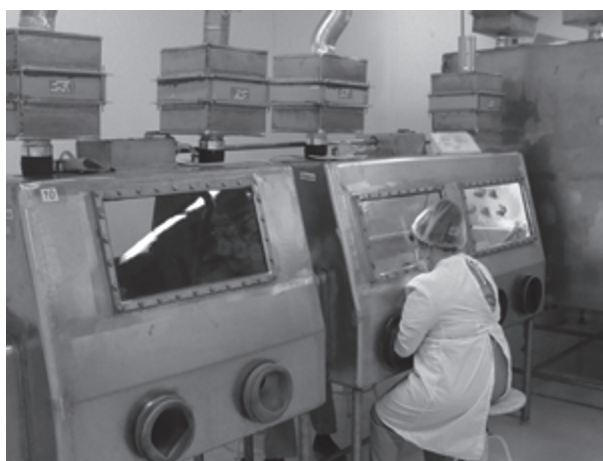
Рисунок 1. — Защитная технологическая линия для работы с патогенными биологическими агентами I группы
