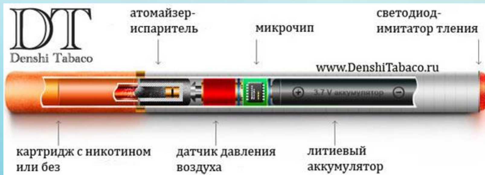
Рис. 1. Схема строения электронной сигареты
