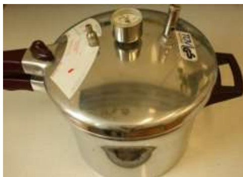
Рисунок 132. Аппарат для холодной полимеризации пластмассы под давлением
