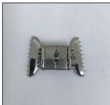
Рис. 50 Изготовленный экспандер в сборе.
