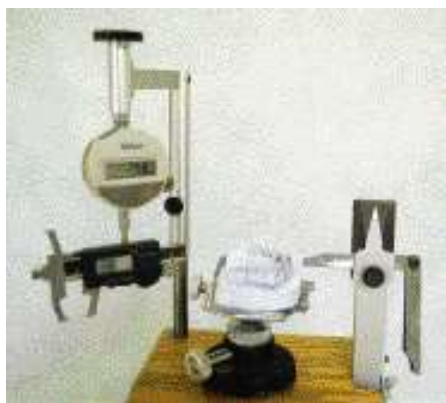
Рис. 27. Аппарат TARG с системой измерения толщины
