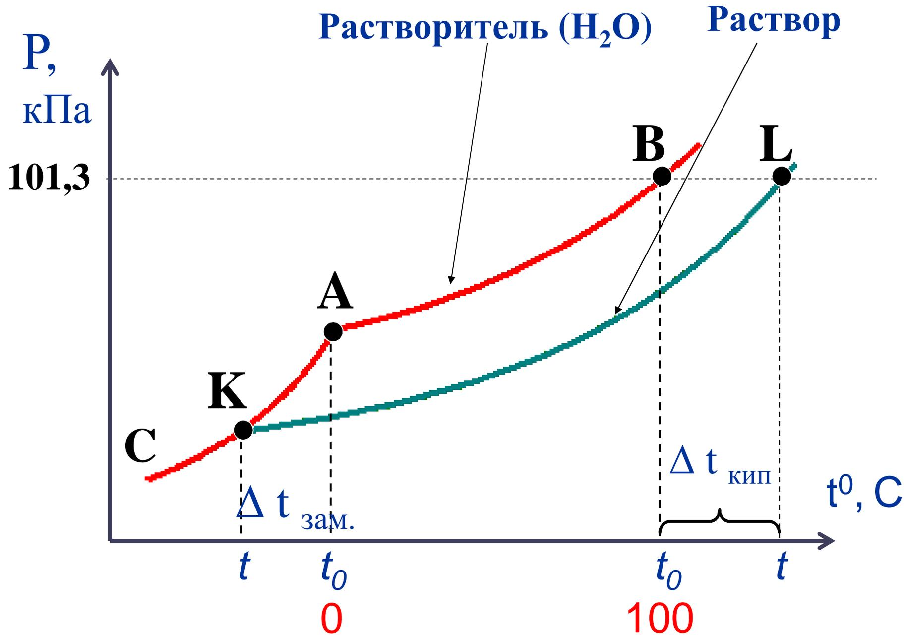
**II закон Рауля (1882)** : «Повышение  $t_{\text{кип.}}$  и понижение  $t_{\text{зам.}}$  растворов пропорционально моляльности растворенного вещества.»
