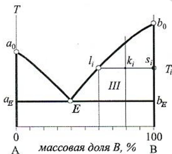
Рис. 5.6. Фазовая диаграмма плавления двухкомпонентной системы с полной растворимостью компонентов в жидком и полной нерастворимостью в твёрдом состоянии с демонстрацией правила рычага
