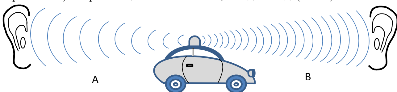
Рис. 8. Схема эффекта Доплера – изменения частоты звуковой волны при движении источника звука в направлении от (А) и к приемнику (В) звука.
