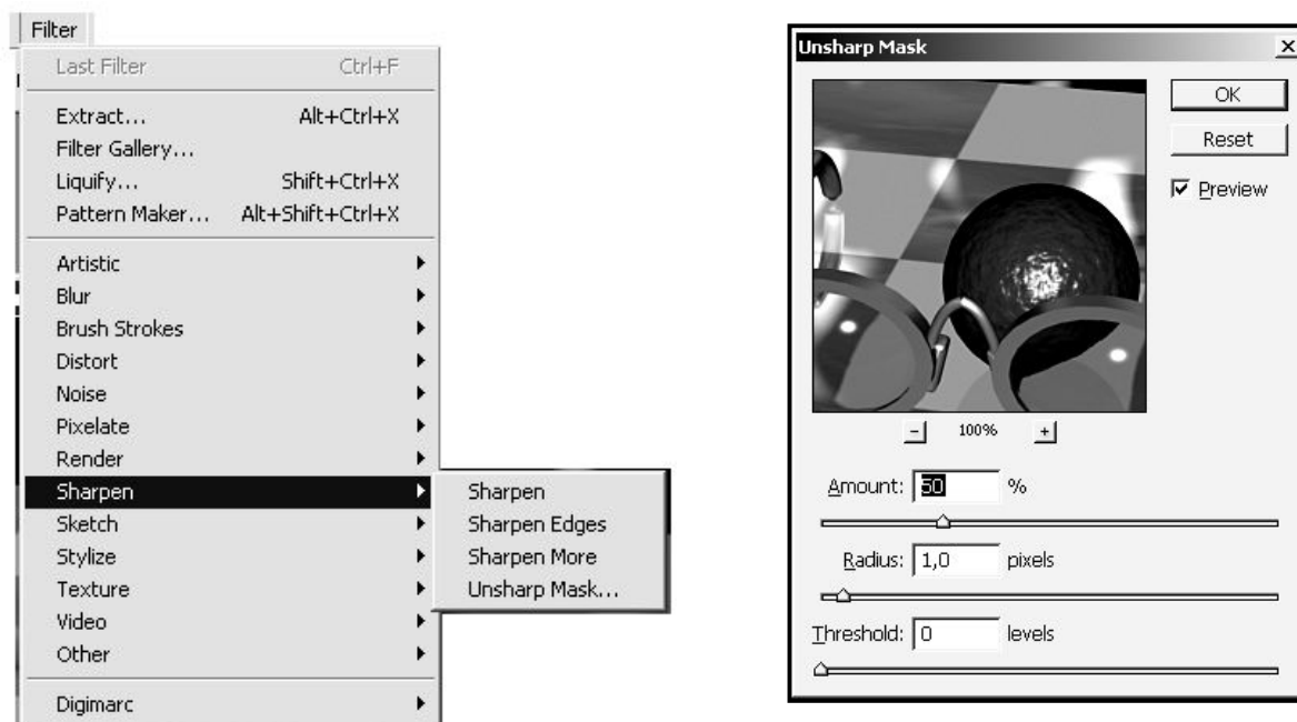
Рис. 24. Вид подменю Sharpen (Резкость) меню Filter (Фильтр) и диалоговое окно Unsharp Mask (Нечёткая маска)
