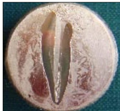
Рис. 6. Шлиф зуба, погруженный в эпоксидную смолу
