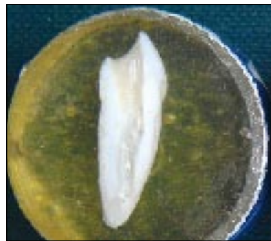
Рис. 6. Шлиф зуба, погруженный в эпоксидную смолу
