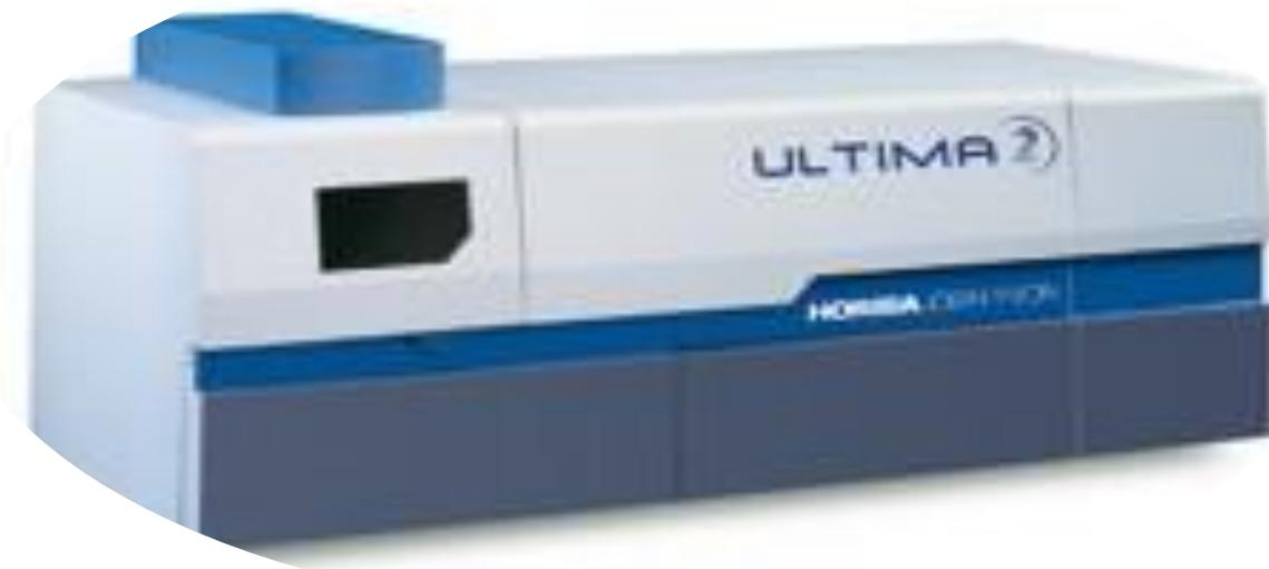
Атомно-эмиссионный спектрометр с индуктивно-связанной плазмой Horiba JY 2000 (Horiba Jobin Yvon, Япония-Франция)
