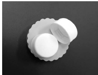
Рис. 6. Заготовка для изготовления заглушки
