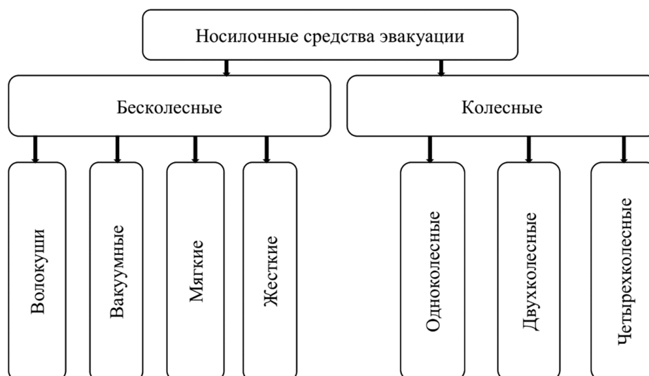
Рис. 2. Предлагаемая классификация носилочных средств эвакуации, основанная на общности характеристик некоторых их групп
