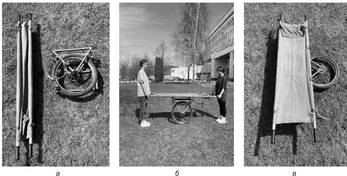
Рис. 4. Эвакуационная тележка «Анютка»: а – в разобранном состоянии; б – в собранном состоянии; в – в позиции залегания
