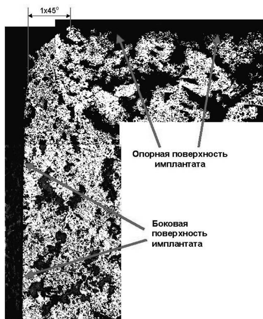
Рис. 15. Панорама поперечного шлифа пористого имплантата позвонка грудного (шейного) отдела. \times 40
