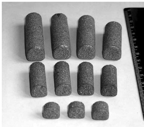
Рис. 14. Внешний вид имплантатов тел шейных и грудных позвонков, межпозвонковых дисков, разработанных РНПЦ травматологии и ортопедии совместно с институтом порошковой металлургии НАН Беларуси
