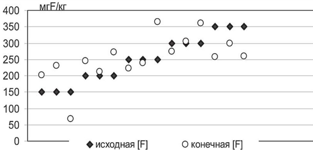
**Рис. 2.** Содержание фторида в соли, приготовленной с заданной концентрацией в диапазоне от 150 до 350 мгF/кг, спустя 4 года хранения.
