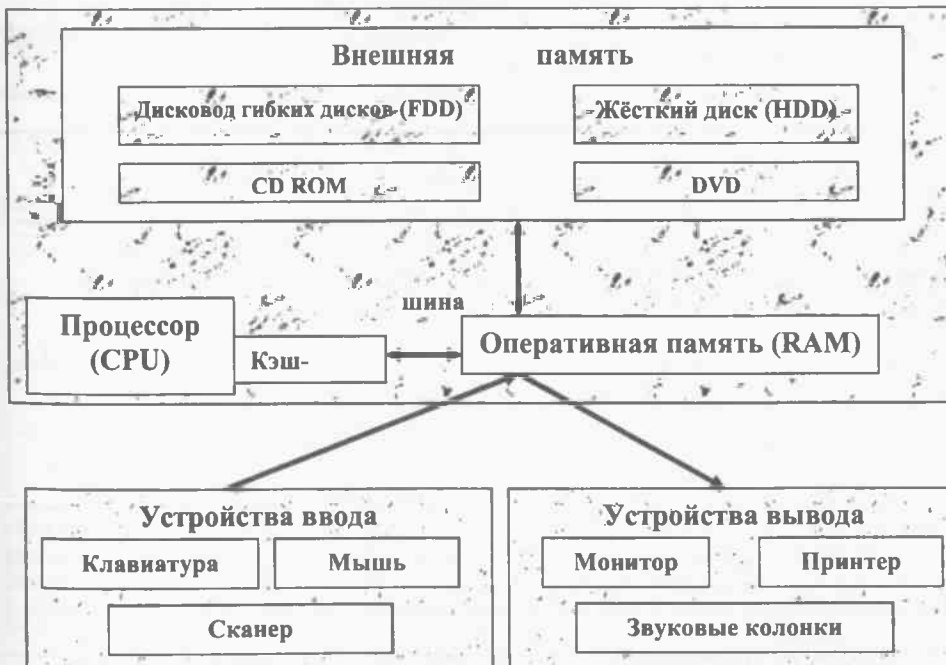
Рис. 1. Схема передачи данных в компьютере
