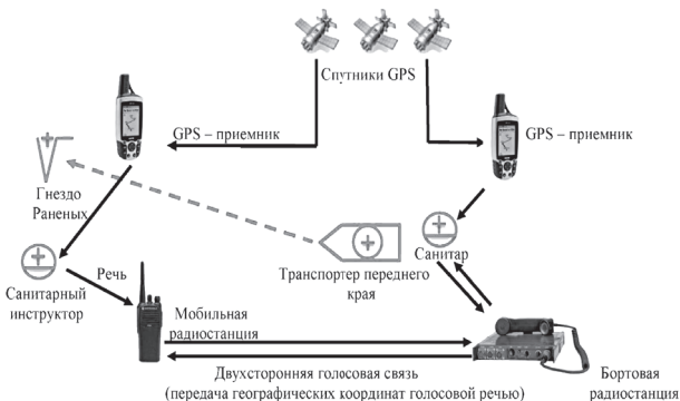
Рис. 4 – Схема передачи информации с использованием GPS-приемников и радиостанций при розыске гнезд раненых
