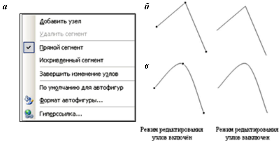
Рис. 11. Действие команд контекстного меню в режиме редактирования узлов линии: а — вид контекстного меню в режиме редактирования узлов; б — при выборе команды Прямой сегмент и добавлении затем узла (промежуточной вершины) на прямой и перемещении этого узла вверх-вправо образуется кривая с изломом; в — результат подобных же действий, но при выборе команды Искривленный сегмент . Образуется гладкая кривая. Первый столбик кривых показывает вид кривых в режиме изменения узлов, а второй — когда данный режим выключен
