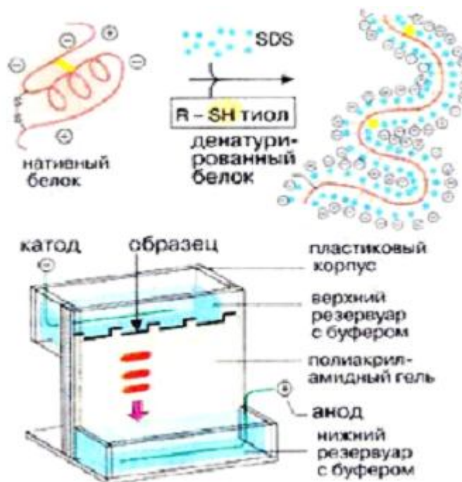
Рис. 2.3. Разделение белков сыворотки крови методом электрофореза
