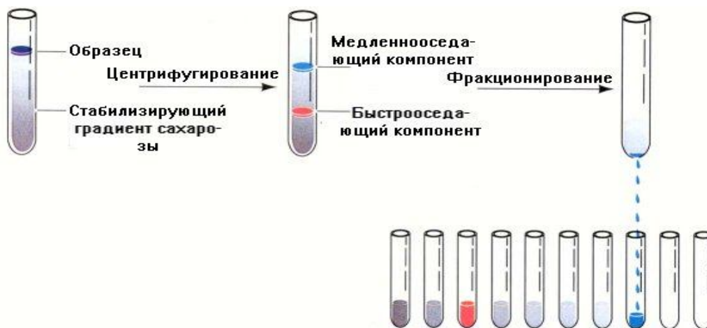
Рис. 2.5. Разделение белков методом ультрацентрифугирования
