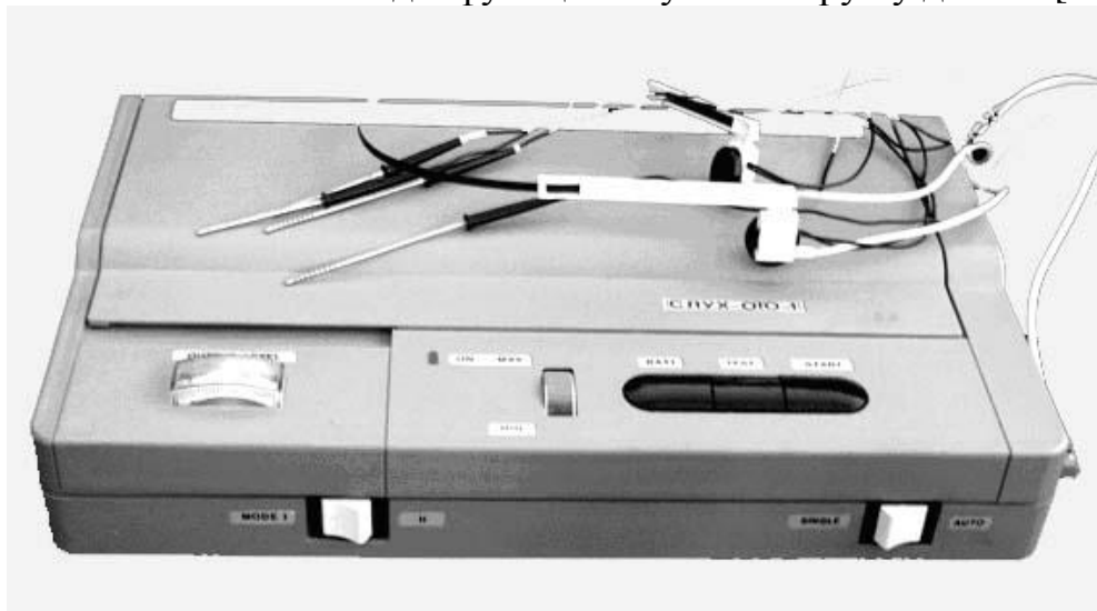
Рис. 58. Аппарат «Слух», используемый для электростимуляции слуховых труб флюктуирующими токами
