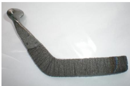
Рис. 1 Эндопротез из сверхэластичного никелида-титана.
