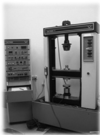
Рис. 3. Универсальная тестирующая машина «Инстрон»
