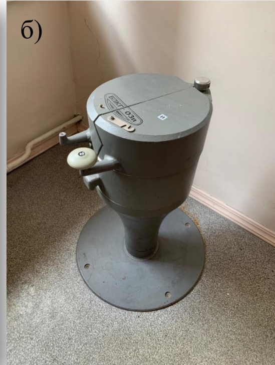
Рис. 5 – Радиометр РУБ-01п с измерительным устройством УИ-38П2 (а) и блоком детектирования БДКГ-03П (б)
