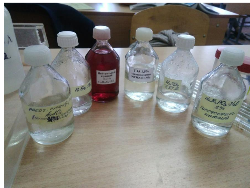
Рис.2- Реактивы для определения нитратов и нитритов в воде.
